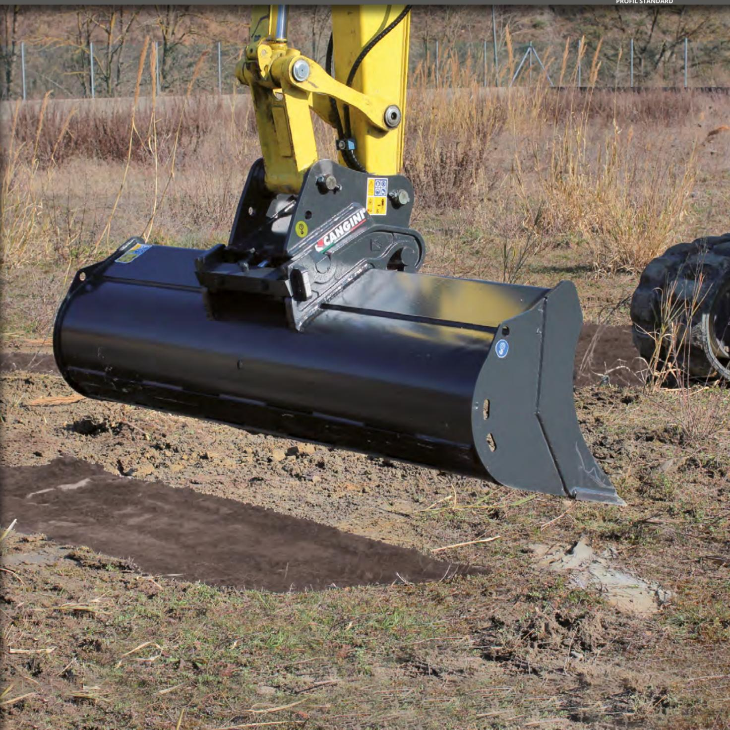
Sa forme élargie et surbaissée le rend adapté à la réalisation et l'entretien de canaux, talus et terrassements. Conçu avec des trous sur les côtés et sur le fond pour permettre le drainage de l'eau.
